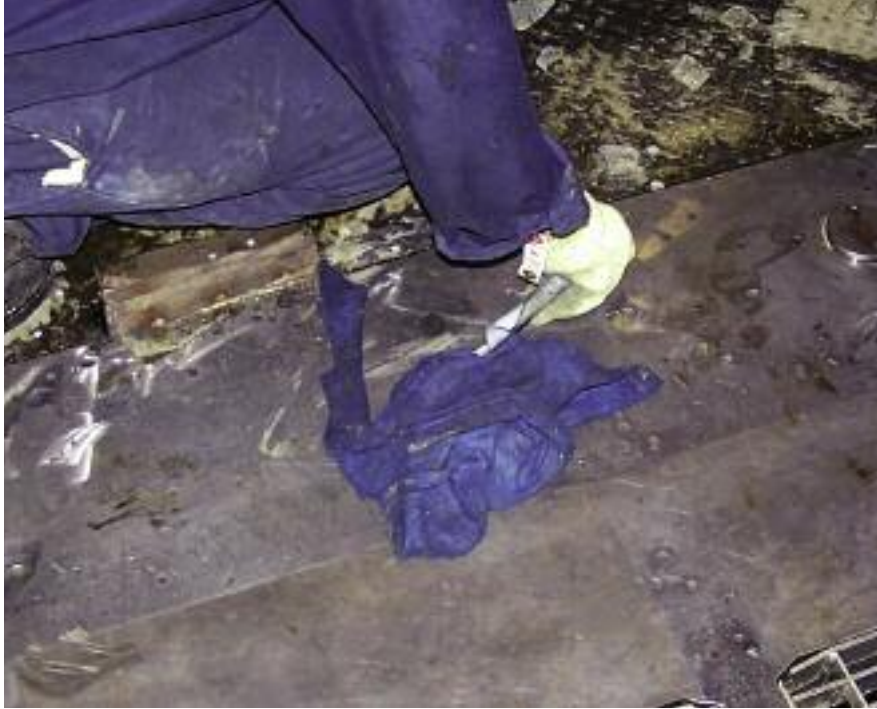
Un recorte debajo de la zapata fuerza al carro a salirse de alineación con respecto a la cama. Aquí el técnico matricero usa un pedazo de lámina para sacar un sobrante incrustado. Nótese que un disco abrasivo se ha usado inadecuadamente para desbastar los puntos altos, afectando la planicidad de la cama de prensa.
